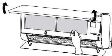
将滤尘网清洗干净，放置在阴凉处晾干
