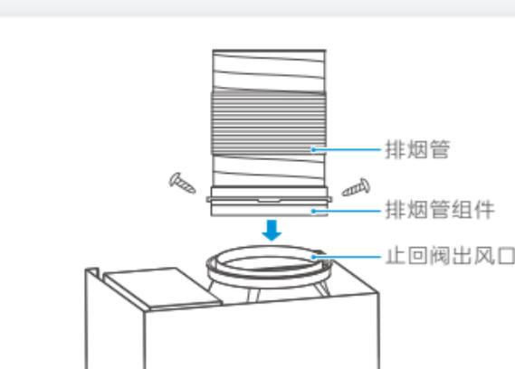
排烟管组件的一端装入止回阀出风口内，再将2枚ST3.9x12扁头自攻螺钉固定(如图所示)，然后用附在烟管的铝箔胶带将排烟管粘在止回阀上;再将排烟管组件的另一端引入到室外或公共烟道接口。
