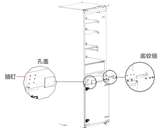
将冷藏门的上铰链和下铰链互换，并安装铰链和上孔盖。
