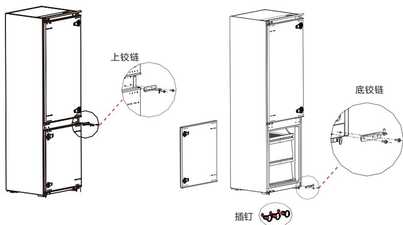
7 将冷冻门的上铰链和下铰链互换，并安装好，安装上孔盖。
