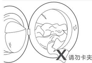
关门时，请确保衣物未被卡夹在密封圈和机门之间，以免机器在运转过程中，拉扯损坏密封圈导致漏水
