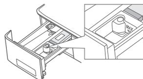
虹吸帽请勿拆卸，以免损坏部件，导致柔顺剂无法投放
