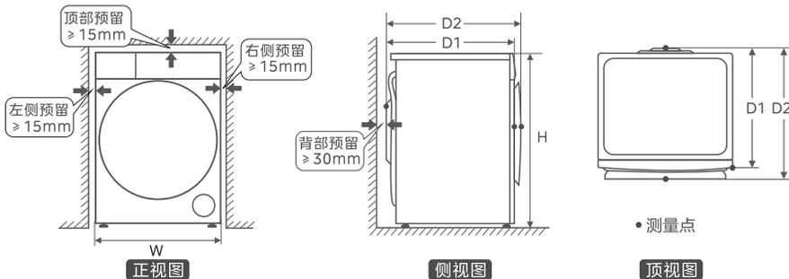
注：标注 \* 的机型，D1/D2机器背部测量点为排水管最突出处，上图仅为示意图。
