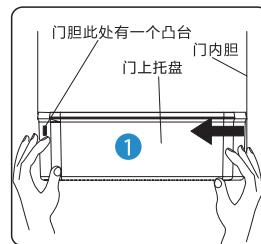
2 安装是斜向把果蔬空间抽屉两侧滚轮导入到导轨内侧，然后推入到止档位置后安装托盘。
