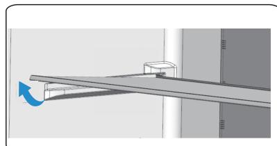
2 安装：双手将玻璃搁架后端推入后槽内，放平即可。
