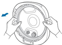
2 将密封圈的四个卡扣 A，对准锅盖的四个缺口 B 卡入，安装到位
