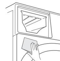
清洁洗涤剂盒下方前封门处，水渍或者洗涤剂残留堆积，会造成外观腐蚀
