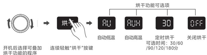
注：选择烘干功能后，机器进行智能称重，数码管显示---，机器智能称重结束后，数码管会显示程序运行预估时间。
