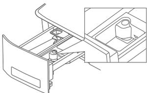
虹吸帽请勿拆卸，以免损坏部件，导致柔顺剂无法投放
