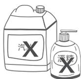
禁止使用具有挥发性、腐蚀性的清洗剂进行清洗，诸如酒精，汽油等
