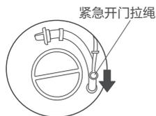
用工具插入拉环内，向下拉，打开洗衣机门锁
