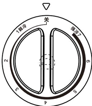
酒柜内的温度是通过温控旋钮来调节的。温控面板上面“1, 2, 3, 4, 5, 6, 7”不代表具体的温度，数字越小，柜内温度越高，数字越大，柜内温度越低。“关”表示停机档。
