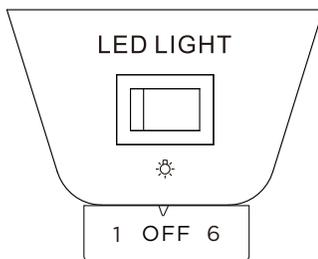
酒柜内的温度是通过温控旋钮来调节的。控制板上“1, 2, 3, 4, 5, 6, OFF”不代表具体的温度，数字越小，柜内温度越高，数字越大，柜内温度越低。“OFF”表示停机档。照明灯可通过灯开关进行调节。
