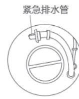
拉出紧急排水管
