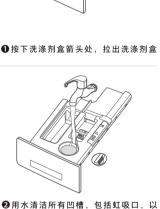
用水清洁所有凹槽,包括虹吸 免堵塞,造成柔顺剂无法投放 包括虹吸口,以
