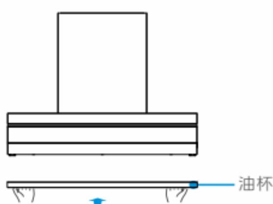
双手握住油杯底部两端，将油杯水平插入油杯支架卡槽中，并沿油杯支架往后推到限位处即可。
