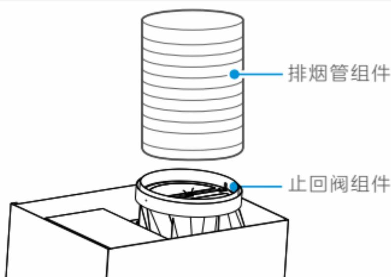
排烟管组件的一端装入止回阀出风口内，再将2枚ST2.9x9.5扁头自攻螺钉固定（如图所示），然后用附在烟管的铝箔胶带将排烟管粘在止回阀上；再将排烟管组件的另一端引入到室外或公共烟道接口。
