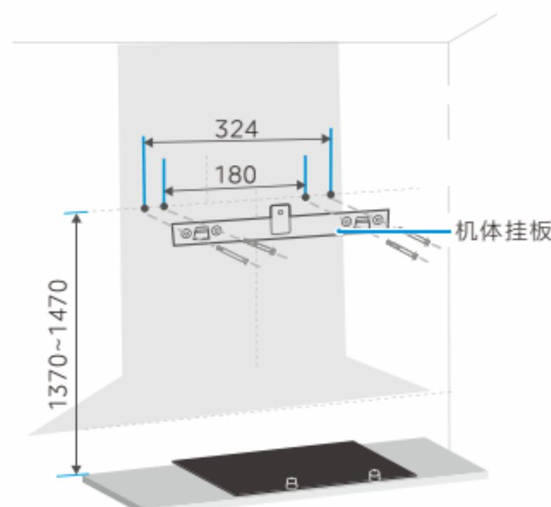
按照如图所示在墙壁相应位置钻出4个直径为10mm、深度50~60mm的孔，将塑料膨胀管压入孔内，再用随机配备的5x50沉头木螺钉将挂板可靠固定。
