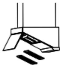
向下拉过滤网使其脱出，取下后，用中性洗涤剂的温水进行擦洗，清洁后将过滤网放回安装好
