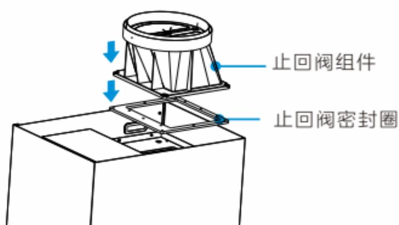
将止回阀组件连同止回阀密封圈安装在出风口位置，用随机配备的ST4x16的自攻螺丝固定，检查并确保阀片转动灵活。
