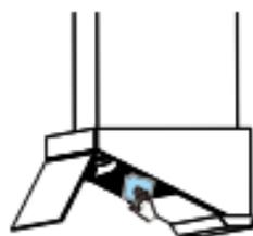
面板打开后，使用中性洗涤剂的温水擦洗导流板四周。
