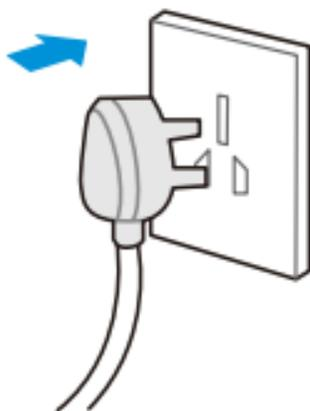
将电源插头插入插座，蜂鸣器提示一声，上面板自动开合，一次自检后，整机进入待机状态。
