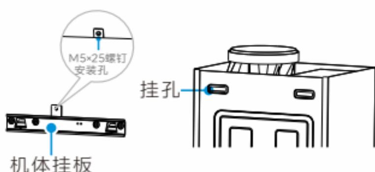
将机体后部的挂孔对准机体挂板的挂钩，从上往下挂入确认机体安装水平和牢固，再将随机所附的M5x25螺钉装入机体挂板顶部螺丝孔内，防止机器意外脱落。
