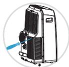
卸下下进风格栅上侧螺钉，取下下进风格栅，取出下侧滤尘网
