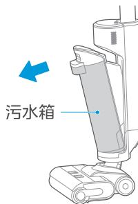
2 将过滤器从污水箱盖中取出。向上拔出污水箱盖，倒出污水；
