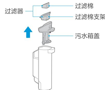
3 用清水冲洗污水箱和污水箱盖，可使用配套的清理刷将污水箱内壁刷洗干净；
