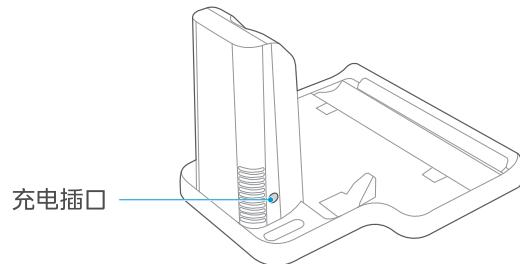
2 将整机直立放入充电底座，确保机身底部完全落入充电底座上，此时会有语音提示“开始充电”，同时屏幕充电指示灯亮起；
