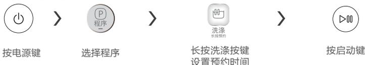
1. 在洗衣程序设定好参数后，程序启动前，同时长按【洗涤】键设置预约时间。
