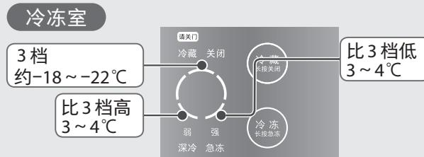
**提示** ● 温度调节档位的显示在触摸操作中断10秒后生效，生效10秒后灭灯。
