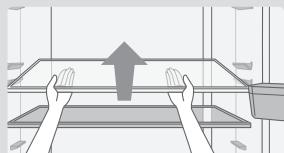
● 安装方式和拆卸方式相反。
