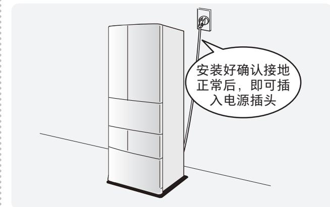
1 请将电源插头插入电源插座
