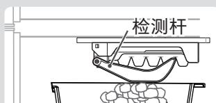
部分冰块堆积在局部区域时，可能会使冰块过早碰到检测杆，导致制冰不足就停止制冰的情况发生。
