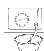
拔下紧急排水管堵头，将管内污水排至水盆或容器内后将堵头塞好
