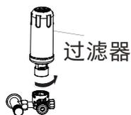
**2** 按过滤器本体上"open"方向旋转拆除过滤器。
