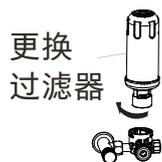
**3** 将全新的过滤器按过滤器本体上"close"方向安装旋入。
