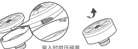
注:必须在微压阀完全冷却后,方可清洗,小心烫伤。
