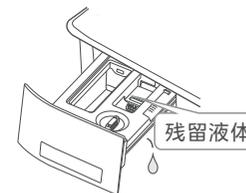
清洗前请先确认洗涤剂、柔顺剂盒内是否有残留液，防止洗涤剂流出，洗衣机挪动或维修前，务必将洗涤剂盒抽出放置于安全地点
