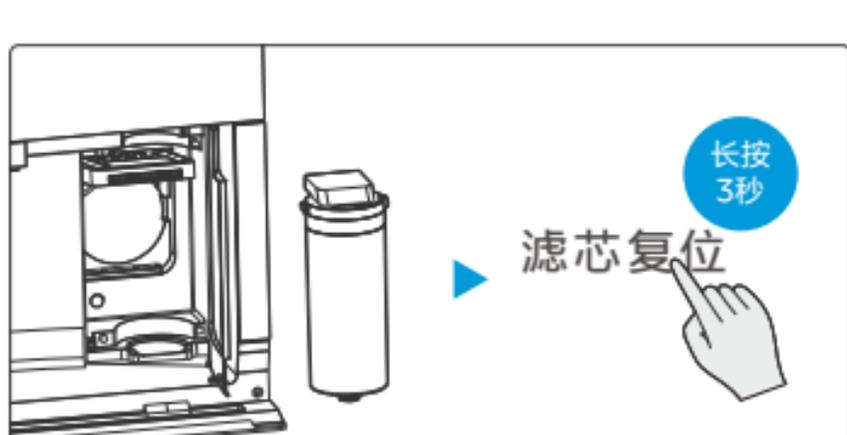
4. 逆向操作装入新滤芯，向下翻转滤芯压杆并压紧直至“啪”一声，盖上滤芯门。滤芯更换完毕后，长按屏幕“滤芯复位”3秒，将滤芯寿命复位
