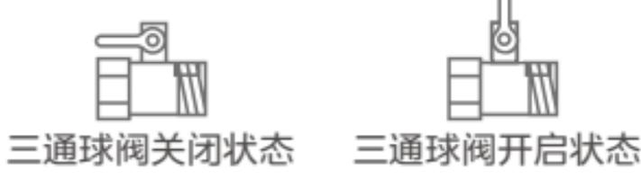
b | 更换滤芯时必须按顺序关闭三通球阀（三通球阀位置：找到机身后方[自来水]接口，沿该接口PE塑料管找到的第一个阀即为三通球阀），然后拔掉整机电源。
