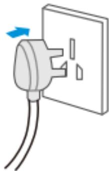
将电源插头插入插座，蜂鸣器提示一声，一次自检后，整机进入待机状态。
