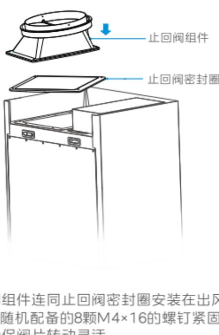
将止回阀组件连同止回阀密封圈安装在出风口位置，用随机配备的8颗M4×16的螺钉紧固，检查并确保阀片转动灵活。
