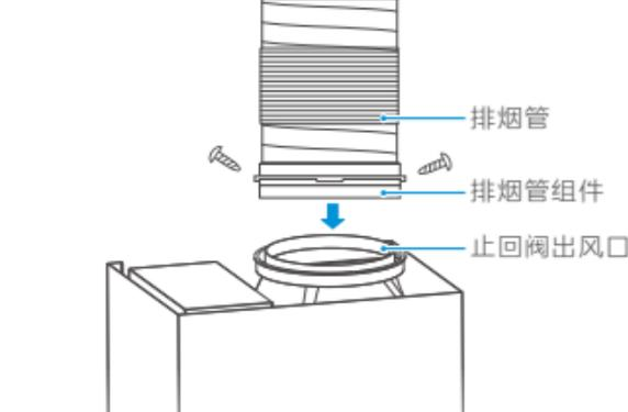
排烟管组件的一端装入止回阀出风口内，再将2枚ST4.9x9.5扁头自攻螺钉固定(如图所示)，然后用附在烟管的铝箔胶带将排烟管粘在止回阀上;再将排烟管组件的另一端引入到室外或公共烟道接口。
