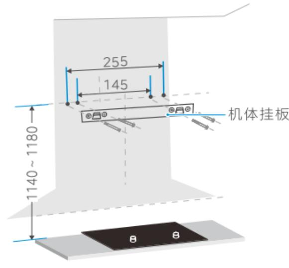
按照如图所示在墙壁相应位置钻出4个直径为10mm、深度50~60mm的孔，将塑料膨胀管压入孔内，再用随机配备的ST5X50扁头自攻螺钉将挂板可靠固定。
