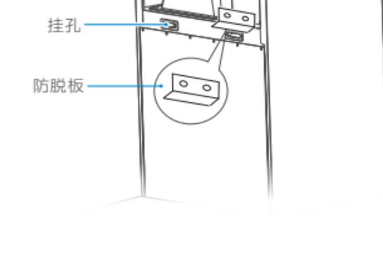
机体后部的挂孔对准机体挂板的挂钩，从上往下挂入确认机体安装水平和牢固，然后在墙上开2个10mm孔，将塑料膨胀管压入孔内，再用随机配备的ST5X50扁头自攻螺钉装入防脱板螺丝孔内，防止机器意外脱落。
