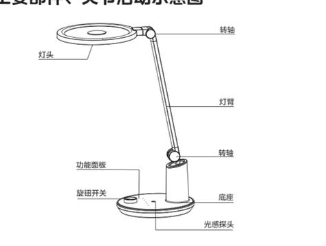
灯头 转轴 灯臂 转轴 底座 光感探头 旋钮开关 功能面板
