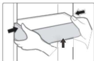
**2 安装：**双手扶住托盘的两侧，托盘两侧凹槽对齐门胆两侧凸台，直接用力把托盘往下按压即可。
