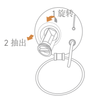
4 使用钳子夹住，向左旋转取下过滤阀
