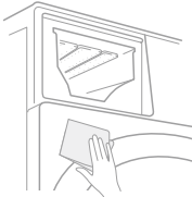
4 清洁洗涤剂盒下方前封门处，水渍或者洗涤剂残留堆积，会造成外观腐蚀
