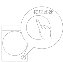
1 拔掉电源插头，轻按，过滤器门自动弹出
