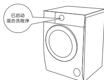
启动除单脱水程序外的一个程序排水(40s)
