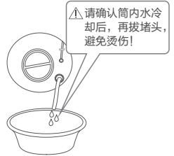
拔掉紧急排水管堵头，将管内污水排至水盆或容器内后将堵头塞好
