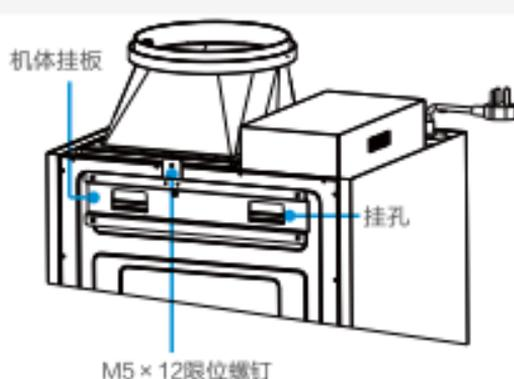
将机体后部的挂孔对准机体挂板的挂钩，从上往下挂入确认机体安装水平和牢固，再将随机所附的M5 × 12螺钉装入机体挂板顶部螺钉孔内，防止机器意外脱落。
