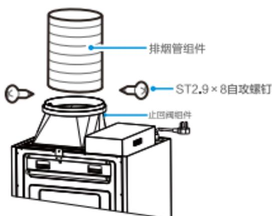
排烟管组件的一端装入止回阀出风口内，再将2枚ST2.9 × 8扁头自攻螺钉固定（如图所示），然后用附在烟管的铝箔纸将排烟管粘在止逆阀上；再将排烟管组件的另一端引入到室外或公共烟道接口。
