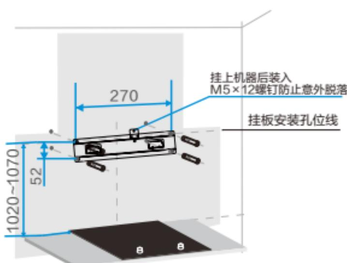
按图所示在墙壁相应位置钻出4个直径为8mm、深度为60-70mm的孔，将塑料膨胀管压入孔内，再用随机配备的5×60十字大扁头木螺钉将机体挂板可靠固定。
