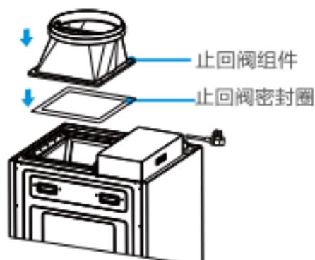
将止回阀组件连同止回阀密封圈安装在机架出风口位置，用整机已有的11颗M4 × 16的螺钉紧固，检查并确保阀片转动灵活。
