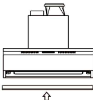
双手握住油杯底部两端，将油杯水平插入油杯支架卡槽中，并沿油杯支架往后推到限位处即可。
