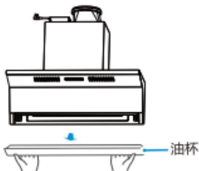
双手水平抽出油杯，倒掉油杯的积油。
