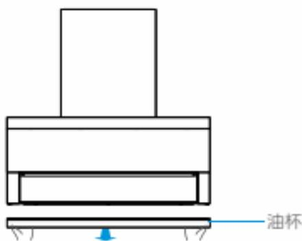
双手水平抽出油杯，倒掉油杯的积油。
