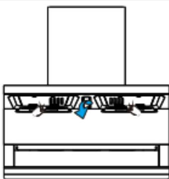
向下沿箭头方向打开导流板，并向外抽取拆下导流板。
