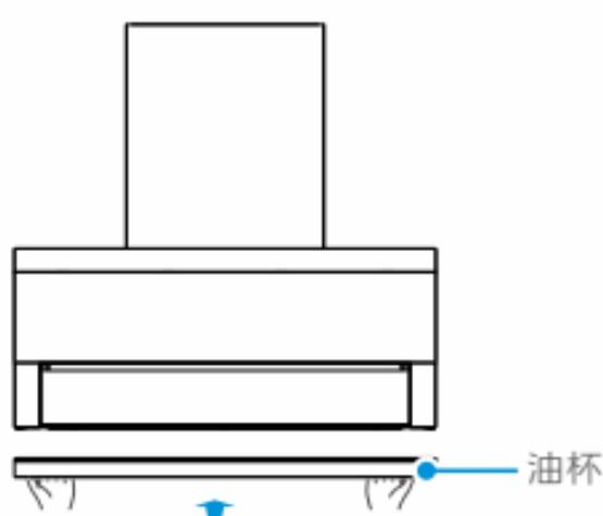
双手握住油杯底部两端，将油杯水平插入油杯支架卡槽中，并沿油杯支架往后推到限位处即可。
