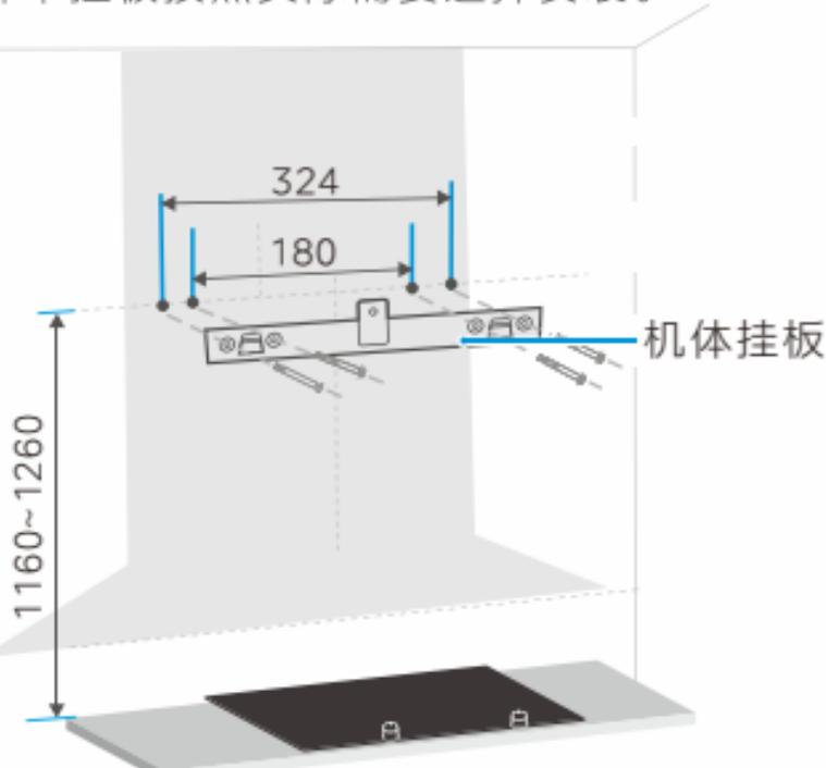
按照如图所示在墙壁相应位置钻出4个直径为10mm、深度50~60mm的孔，将塑料膨胀管压入孔内，再用随机配备的5x50沉头木螺钉将挂板可靠固定。
