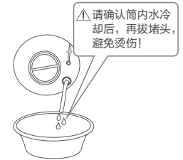
拔掉紧急排水管堵头，将管内污水排至水盆或容器内后将堵头塞好 ⚠ 请确认筒内水冷却后，再拔堵头，避免烫伤！
