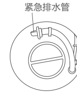
拉出紧急排水管
