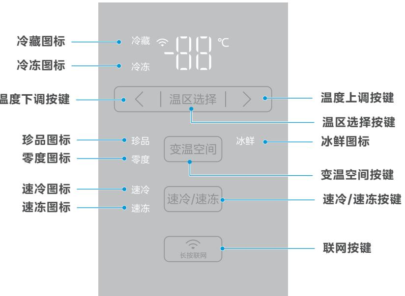
温馨提示：此显示面板按键非触摸式，需按压生效。按压显示面板会有蜂鸣提示音。
