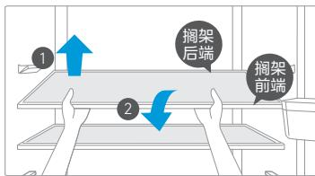
第③步：将搁架水平旋转直至可以顺利取出。
