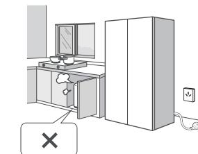
当煤气等易燃气体泄露时，应先关闭气体泄露阀门，再打开门窗，此时切勿拔下冰箱等电器插头，以免产生电火花引发火灾。
