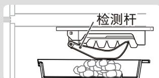
部分冰块堆积在局部区域时，可能会使冰块过早碰到检测杆，导致制冰不足就停止制冰的情况发生。
