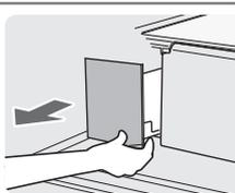
(3) 待“制冰清洗”模式结束，蜂鸣器提示音响起，打开制冰室门，倒掉储冰盒中的水和冰。
