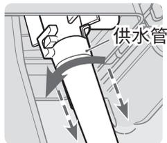
2 将供水泵从供水管上拆下。
