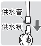
3 将泵盒盖按箭头方向旋转拆下。
