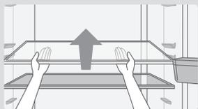
● 安装方式和拆卸方式相反。
