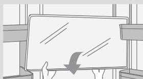
3 将玻璃搁架左右旋转角度即可取出。
