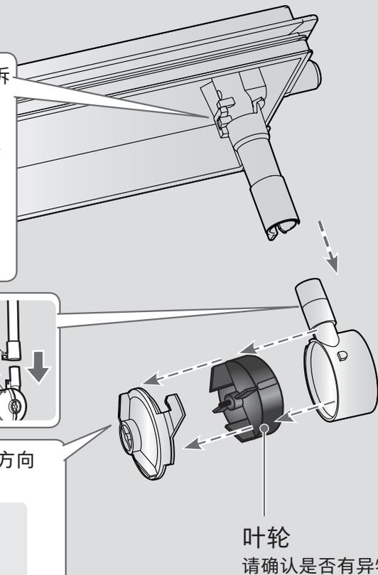
安装方式和拆卸方式相反。
