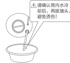
拔下紧急排水管堵头，将管内污水排至水盆或容器内后将堵头塞好
