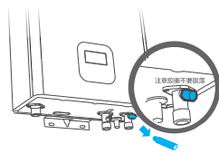
拧开安全阀排水，排完水后，装好安全阀即可。
