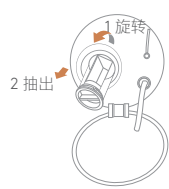
4 使用钳子夹住，向左旋转取下过滤阀
