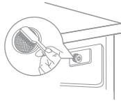
2 用毛刷清洗进水阀处过滤网
