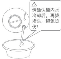
3 拔下紧急排水管堵头，将管内污水排至水盆或容器内后将堵头塞好
