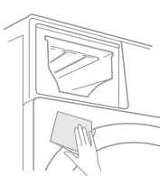
4. 清洁洗涤盒下方前封门处，若水渍或者洗涤剂残留堆积，会造成机器外观腐蚀
