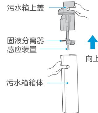
3 从污水箱侧面倾倒污水并冲洗干净；将过滤棉从污水箱上盖取出后冲洗干净并晾干；
