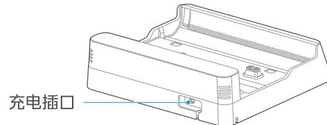
2 将整机直立放入充电底座，确保机身底部完全落入充电底座上，此时会有语音提示“开始充电”，同时机身指示灯闪烁；
