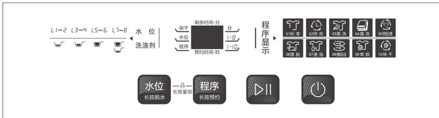
**1 电源** 对洗衣机电源进行开关，长按电源按键，洗衣机进入待机状态。
