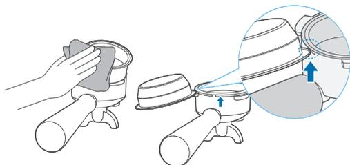
**2** 拿出接水盘，倒掉内部的咖啡液及废水，用清水清洗接水盘与金属垫，并用干布擦干
