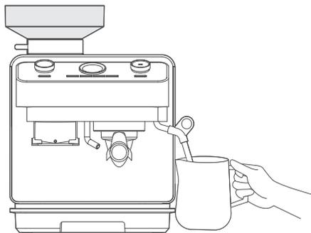
7 按下【启动 / 暂停】键，直到有蒸汽喷出，牛奶在拉花缸里形成漩涡
