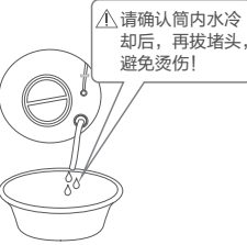
拔下紧急排水管堵头，将管内污水排至水盆或容器内后将堵头塞好
