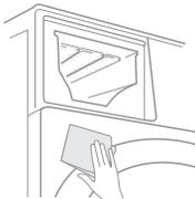
4. 清洁洗涤剂盒下方前封门处，若水渍或者洗涤剂残留堆积，会造成机器外观腐蚀
