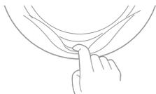
门封是橡胶制品，脏污及水渍残留较易产生霉菌发黑，建议每次使用完，及时擦拭干净
