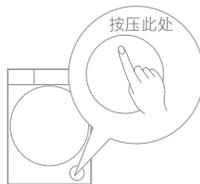
1.拔掉电源插头，轻摁过滤器门自动弹出
