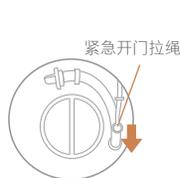
4.用工具插入拉环，向下拉，打开洗衣机门锁
