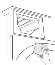
清洁洗涤盒下方前封门处，水渍或者洗涤剂残留堆积，会造成外观腐蚀
