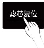
2、若滤芯未到期，提前进行换芯操作，单击[滤芯复位]按键选中滤芯，FPC/RO依次切换，再进行长按[滤芯复位]按键3秒，则选定滤芯的滤芯寿命进行复位。
