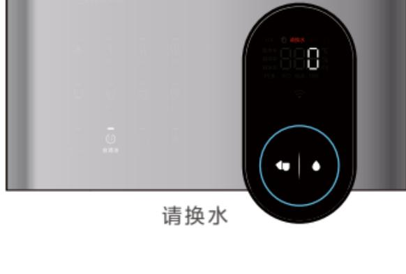
c | 机器冲洗过程中显示界面不能操作，[请换水]文字常亮前不要提起原水箱，重复步骤2三个循环后可完成冲洗，进入制水模式[制水中]文字闪烁。
