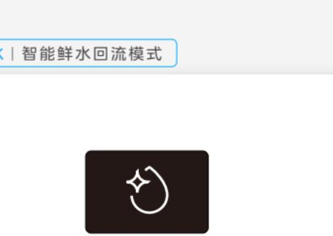
1. [制水中]文字闪烁，[水滴]按钮半亮，此时机器缺水并处于制水状态，此时点击[水滴]按钮，听到“滴滴”声音表示机器缺水，无法取水；
