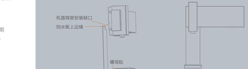
4、整机安装完成后，将挡水板上边缘对准机器背部安装缺口，插接到位置；从附件袋中取出螺钉，在墙上钻孔后安装膨胀胶粒并用螺钉将挡水板及螺母粒固定在墙上；安装完成后将接水盒固定在螺母粒上。
