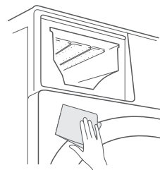
清洁洗涤剂盒下方前封门处，水渍或者洗涤剂残留堆积，会造成外观腐蚀
