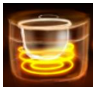
第2代 底部蝶形IH 加热功率大 无法立体加热
