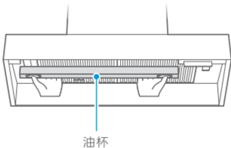
双手托住油杯，沿内腔前壁向上推入安装位。
