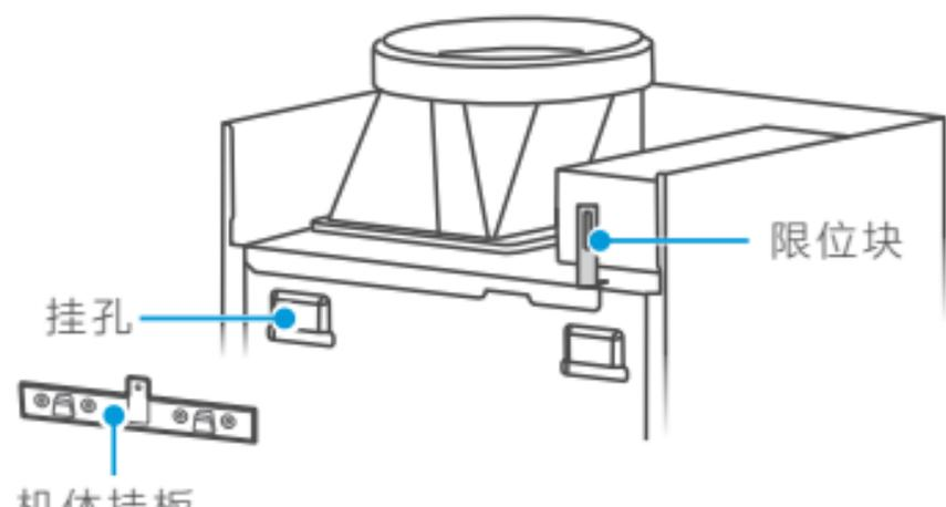
将机体后部的挂孔对准机体挂板的挂钩，从上往下挂入确认机体安装水平和牢固，将限位块顶住烟机，并用ST5\*45扁圆头螺钉将限位块可靠固定，防止机器意外脱落。
