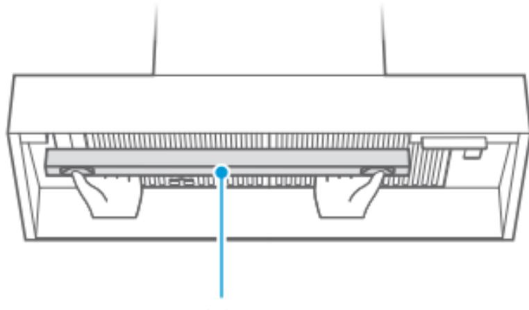
双手托住油杯，沿内腔前壁向上推入安装位。
