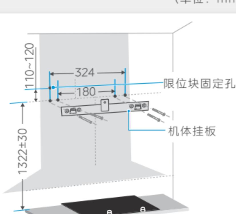
按图示在墙壁相应位置钻出5个直径为10mm，深度为50-60mm的孔，其中上侧的单独孔用来固定限位块。将塑料膨胀管压入孔内，再用随机配备的5×50沉头木螺钉将机体挂板可靠固定。
