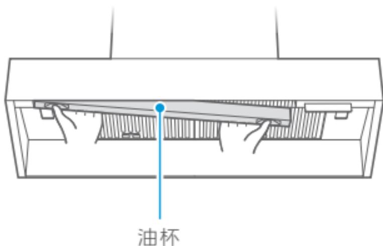
双手托住油杯，双手拇指按在凹槽内，左手不动，右手水平向前方推出油杯。
