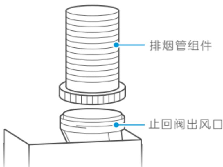
将排烟管固定圈套在排烟管组件上，并用止回阀固定圈固定。再将排烟管的另一端引至室外或者公共烟道中。
