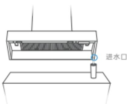
将水杯导水管，插入进水口。
