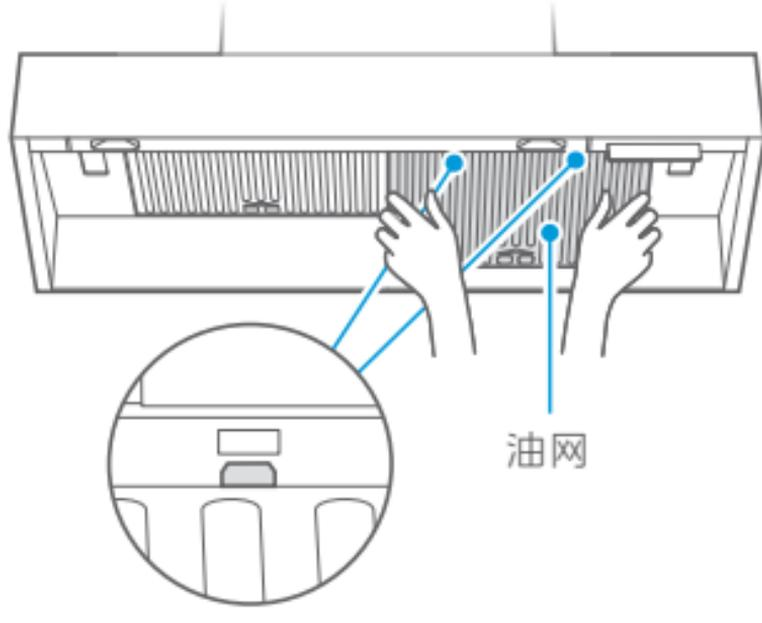
双手拿起油网，箭头朝向操作者，观察内腔前部的安装槽，将油网左右对齐后插入安装槽，再向上推入安装位。
