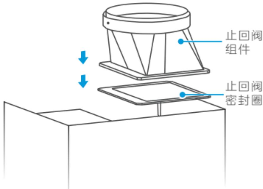
将止回阀组件连同止回阀密封圈安装在出风口位置，用随机配备的ST4.2×16螺钉紧固，检查并确保阀片转动灵活。
